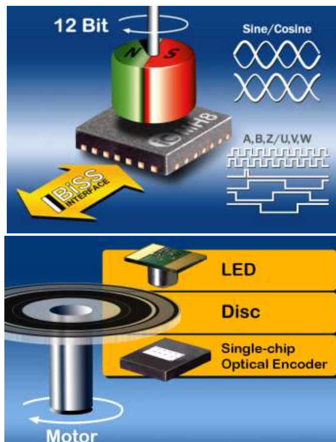
図-3: シングルチップICを使用した磁気式(磁石ローター)と光学式(LED+ディスク)
